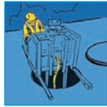
3 Remplacement du branchement plomb sans tranchée
