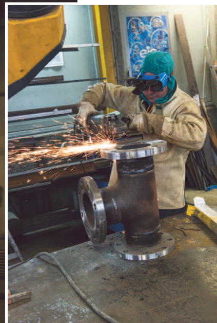
Soudure et finition d'un T sur mesures.
