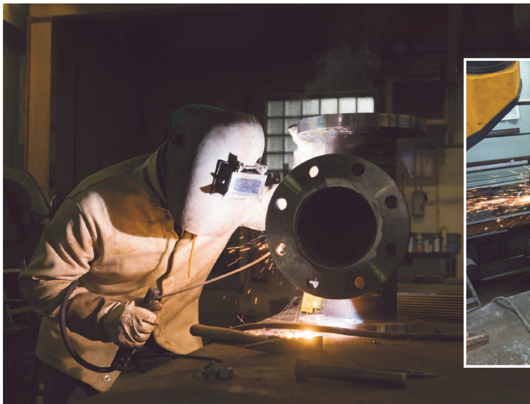
Soudure et finition d'un T sur mesures.
